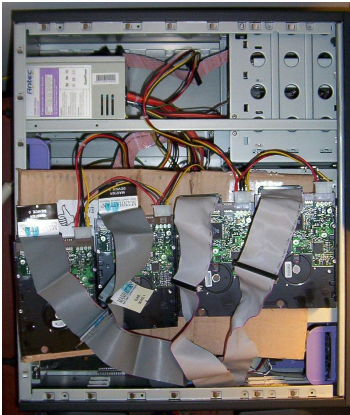
Рисунок 5 массив из четырех дисков — проблемы монтажа
