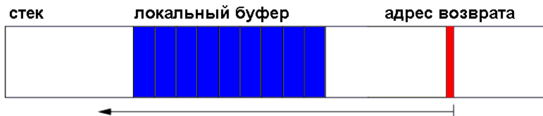
Рисунок 1 схематичное изображение стека. стрелка показывает направление в котором растет стек. локальный буфер "растет" в противоположном направлении и при определенных обстоятельствах может затирать адрес возврата
